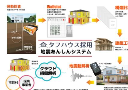
国土交通省 住宅産業技術イノベーション促進事業に採択。地震波による解析結果を耐震設計に反映し、地震発生後、クラウド環境を利用して損傷解析結果を提供。
