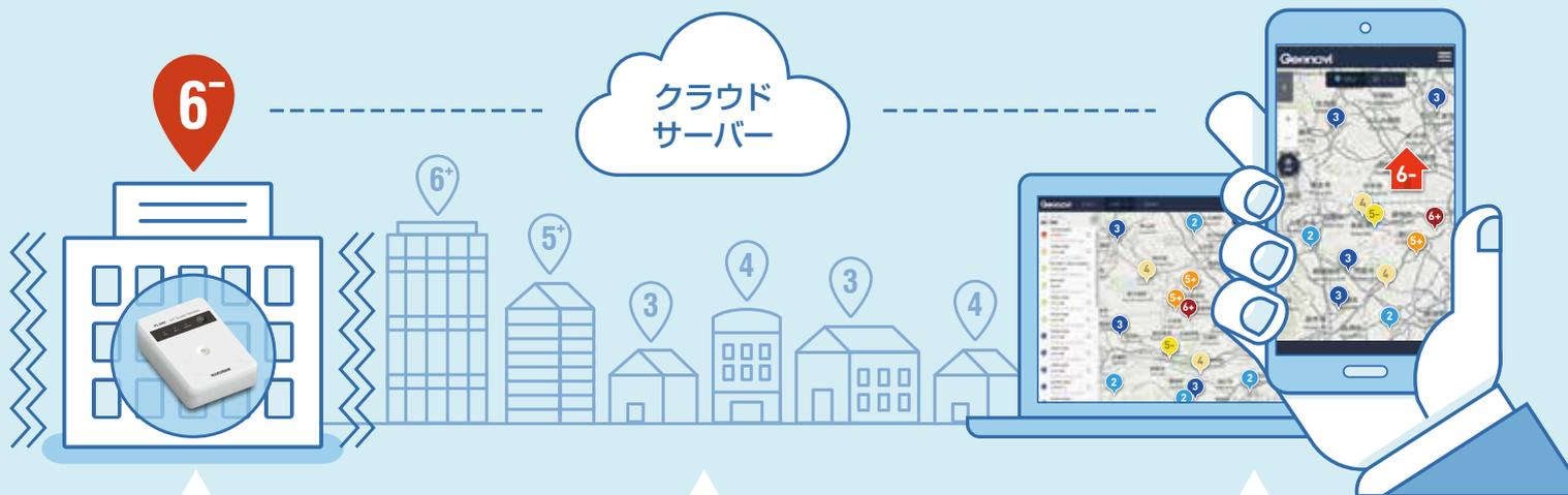
各建物に設置した地震計で地震の揺れを計測
