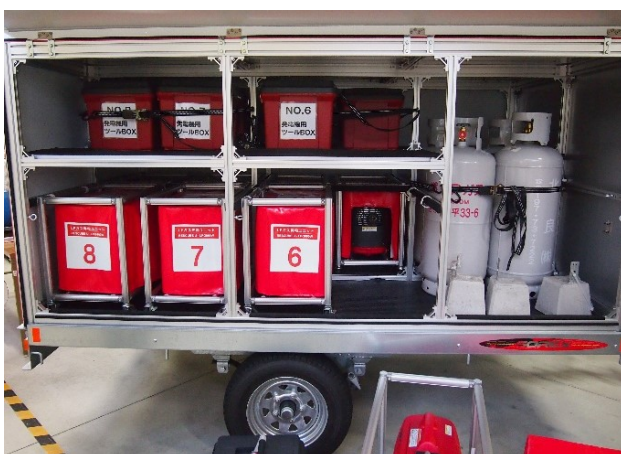
左上・左下：同社が開発した災害支援車両。トレーラーには、ガスボンベと発電機 8 ユニットが積まれている
